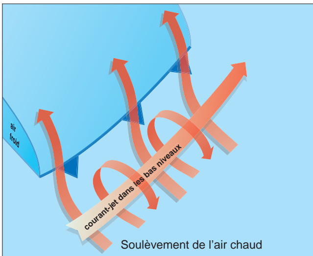
Fig. 2-8 - Les vents complexes entourant un courant-jet à basse altitude peuvent causer un fort cisaillement du vent et beaucoup de turbulence
